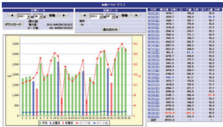
運用されている使用電力監視画面（サンプル）
